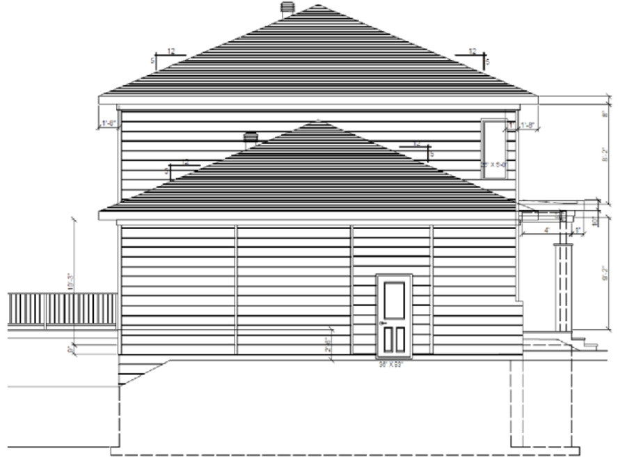
ÉLEVATION GAUCHE Echelle: 6" = 1'-0"
